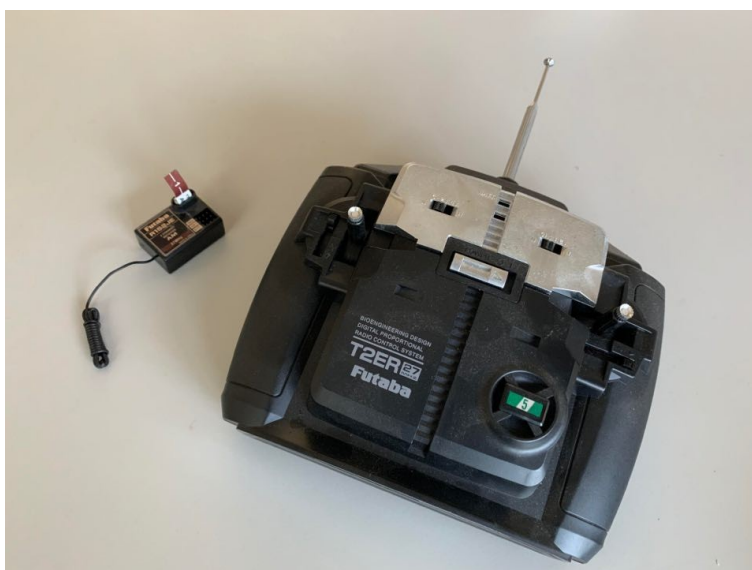
市售 3 通道 27MHz 板型遙控收發器
